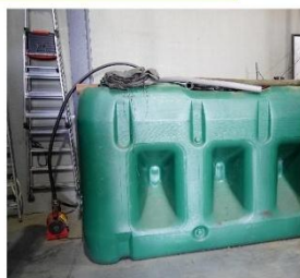
Voorbeeld van bovengrondse enkelwandige metalen tank, links (bron: all tank solutions), rechts bovengrondse enkelwandige kunststof opslagtank op de vul- en spoelplaats geplaatst (bron Inagro).
