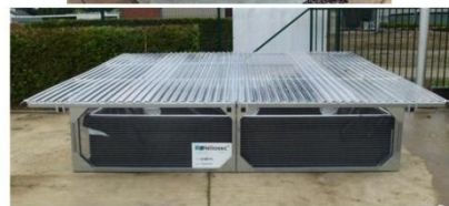
Voorbeelden van fysico-chemische zuiveringssystemen/afvalverwijdering op basis van verdamping (bron: Inagro)
