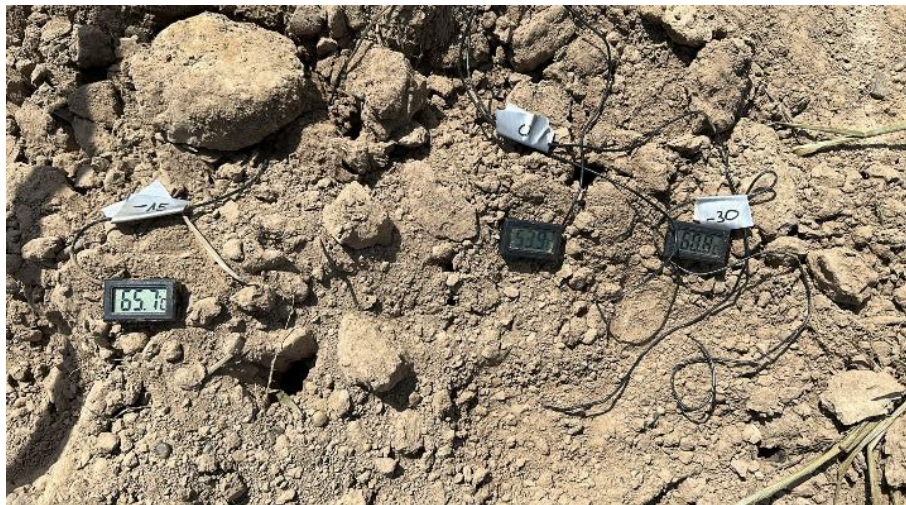
Figuur 4: representatief beeld van de stoomlocatie in leemgrond, enkele uren na de stoomtoepassing
