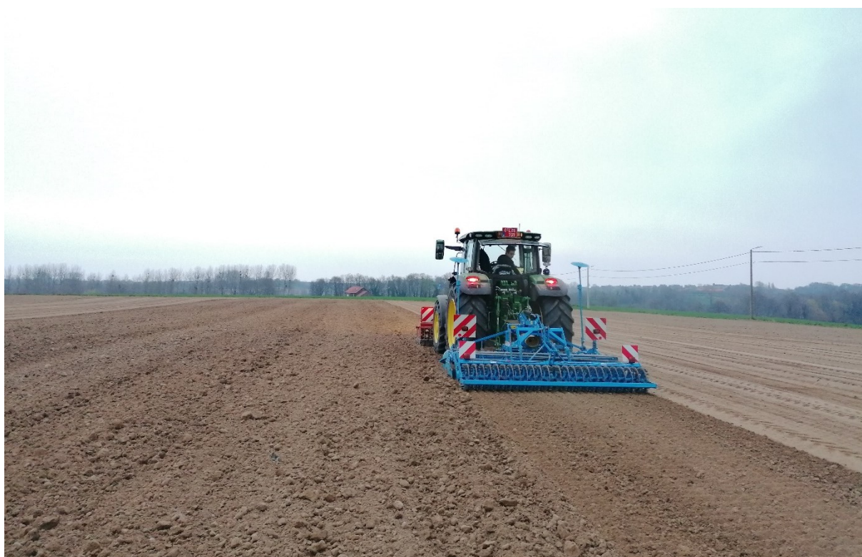
Figuur 4. Combinatie frontwerktuig - Rotoreg- croskilette.
