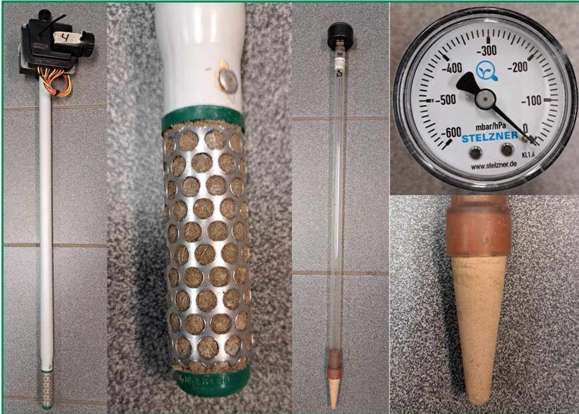
Figuur 11 Watermarksensor met LoRA-module voor communicatie van gegevens (links) en tensiometer (rechts)
