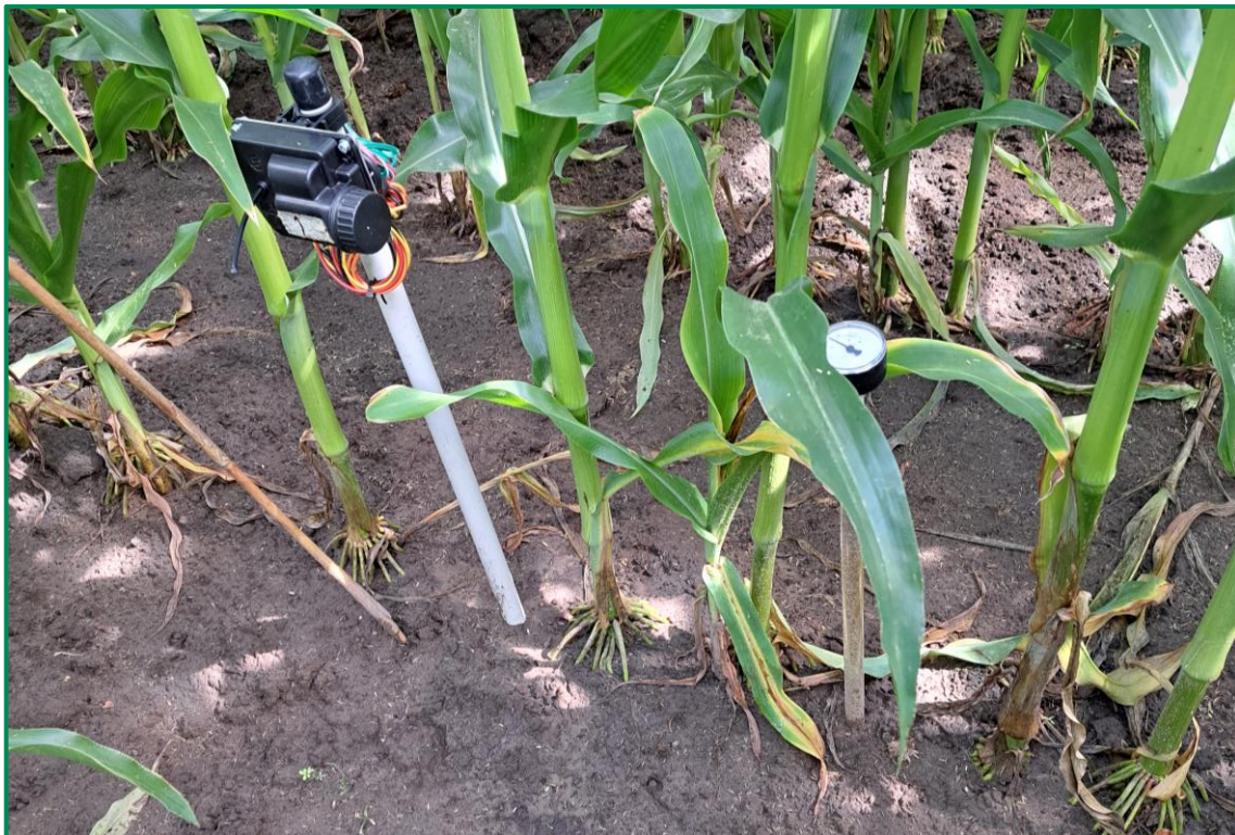
Figuur 12 Een Watermarksensor en een tensiometer beide geplaatst in de maïsrij
