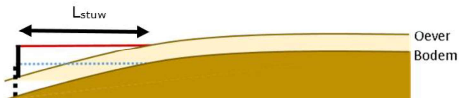
Figuur 1: Zijwaartse schets van het lengteprofiel van de bodem van de gracht en evenwijdige oever. Bij de aanname dat de bodem en de oever eenzelfde hellingsgraad hebben, zal de stroomopwaartse stuwaafstand L_{stuw} gelijk zijn.
