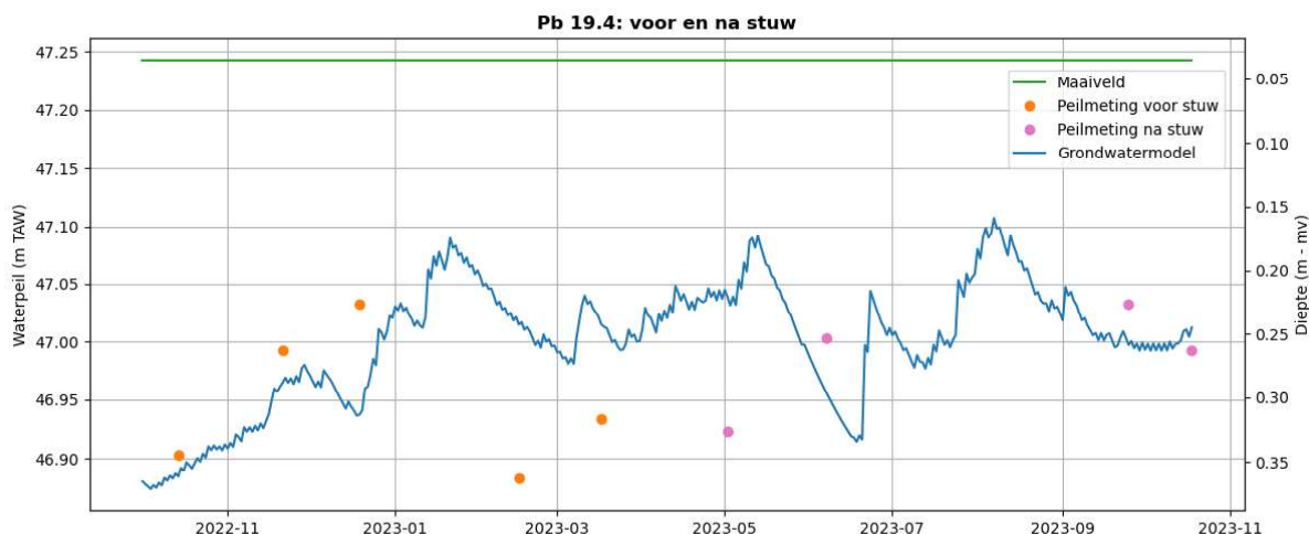
Figuur 25: Vergelijking van het gesimuleerde grondwaterniveau voor peilbuis 19.4 (gekalibreerd a.d.h.v. de beschikbare meetreeksen voor de stuwplaatsing) met de meetreeksen zowel voor als na stuwplaatsing.
