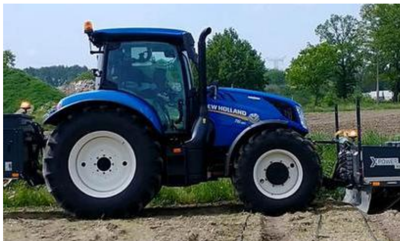
Elektrocutie slaagt erin om de scheuten van knolcyperus thermisch uit te schakelen. Foto: Jeroen Feys
